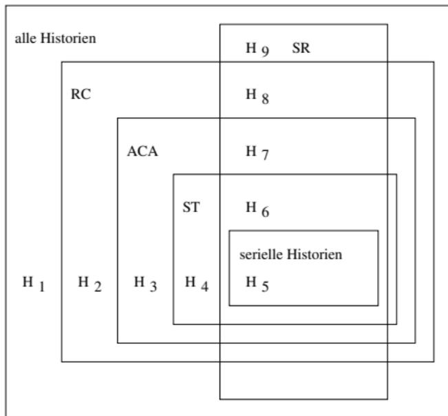
SR: serialisierbar, RC: rücksetzbar, ACA: vermeidet kaskadierendes Rücksetzen, ST: strikt
